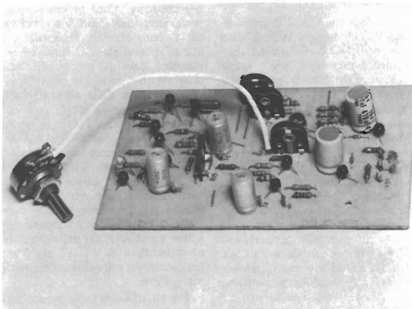
Fig. 5 - Prototipo del VCO a realizzazione ultimata.
